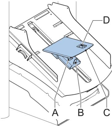
2. Die Zuführplattenvorrichtung **C** in die hintere Position schieben
