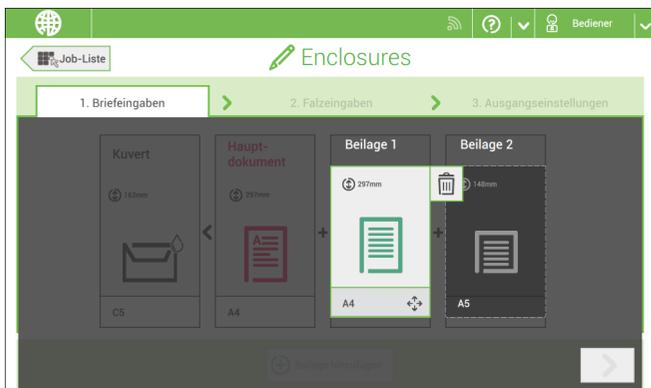
Die Beilage an eine andere Position ziehen. Oder auf den Papierkorb tippen, um die Beilage aus der Briefsendung zu entfernen.
