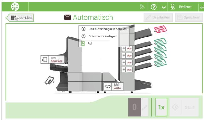
3. Füllen Sie das Kuvertmagazin, legen Sie Ihre Dokumente ein und tippen Sie auf **[1x]**, um eine Testbriefsendung zu erstellen.
