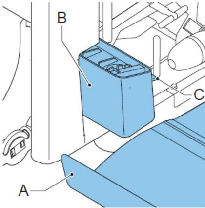
2. Flüssigkeitstank **B** bis zum Rand **C** mit Verschlussflüssigkeit füllen.
