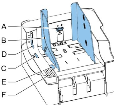
1. Die Separation öffnen, indem der Entriegelungshebel **D** in die obere Position gebracht wird.
