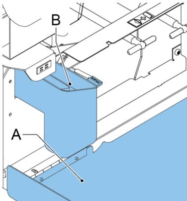
2. Den Verschlussflüssigkeitstank **B** aus dem System entfernen.
