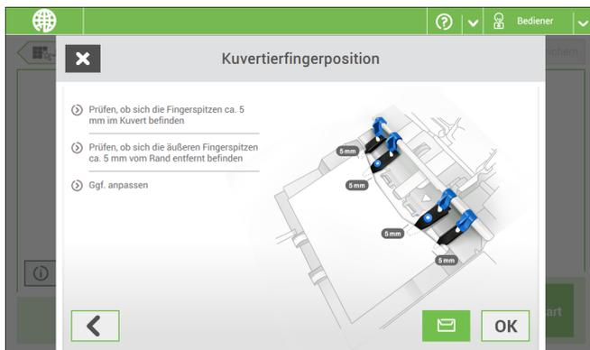
**Falls die Kuvertierfinger nicht richtig positioniert sind, Finger wie folgt anpassen:**
