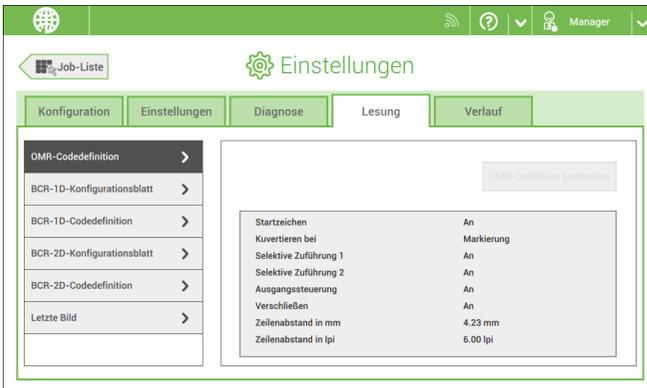
Der Bildschirm "OME-Codedefinition" unter "Lesung" zeigt die Konfiguration des Systems für OME an. Für jede OME-Codeoption wird "Ein" oder "Aus" angezeigt. Bei "Ein" zeigt der Bildschirm Informationen an, was das System tut, wenn es eine Markierung oder keine Markierung liest.
