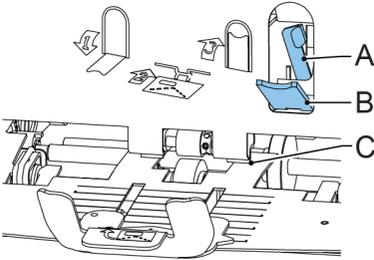
1. Kleinen Hebel **B** nach unten ziehen. Stift **C** wird abgesenkt.
