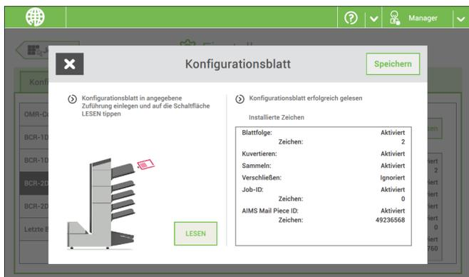
Mithilfe des BCR-1D-Konfigurationsblatts unter "Lesung" können Sie ein Konfigurationsblatt lesen. Das Ergebnis wird auf diesem Bildschirm sowie auf dem Bildschirm "BCR-1D-Codedefinition" dargestellt. Siehe [Lesen eines Konfigurationsblattes](#).
