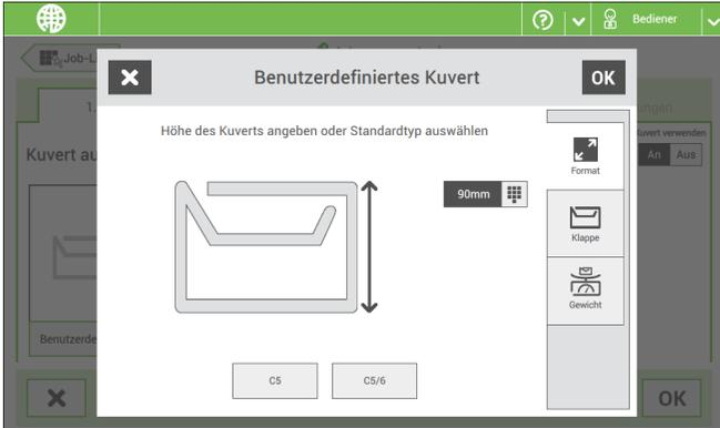
4. Auf die Registerkarte [**Klappe**] tippen, falls Sie Kuverts mit offener Klappe verwenden.
