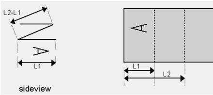
Die Position der beiden Falze kann eingestellt werden. Synonym: Zickzackfalz
