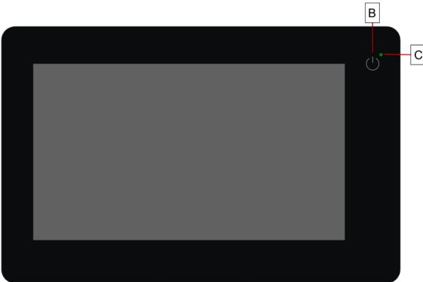
Ein/Aus (B): Über die berührungsempfindliche Taste oben rechts an der Anzeige kann das System ein- und ausgeschaltet werden. Wenn das System über eine Stunde lang nicht verwendet wird, schaltet das System automatisch ab, um Strom zu sparen.
