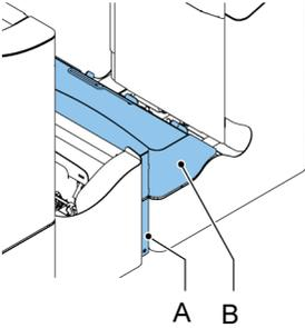
1. Unteres Ende des Sperrgriffs **A** zum Öffnen der Abdeckung der Falzeinheit **B** drücken.
