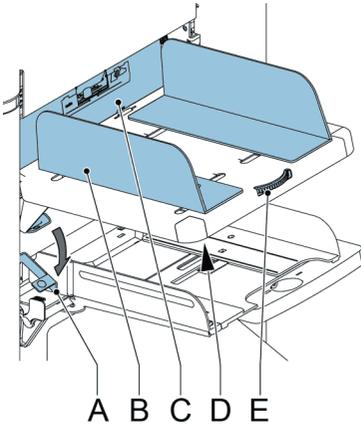
1. Knopf **D**, der sich unterhalb der Zufuhrablage befindet, um eine halbe Drehung lösen.
