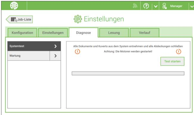
3. Alle Dokumente und Kuverts entnehmen und alle Abdeckungen schließen, bevor die Diagnose gestartet wird.
