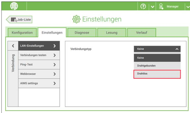
4. Wählen Sie **Drahtlos** aus dem Pull-down-Menü **Verbindungstyp** aus.
