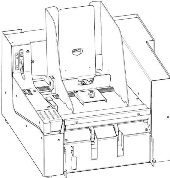
Der versaFeeder wird zum Zuführen von Broschüren, unabhängig von der Dicke des Deckblatts, in den Dokumentenfluss aus der Zuführung zum Kuvertierer verwendet. Aufgrund der Position des versaFeeder (unterhalb des Zuführungsmoduls) werden vom versaFeeder zugeführte Dokumente nicht gefalzt.
