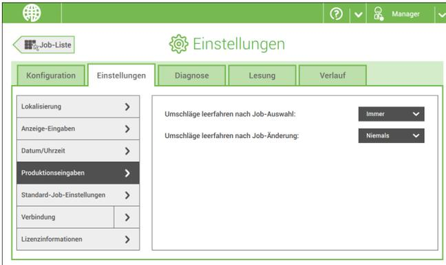
Auf **[Produktionseinstellungen]** tippen, um zu definieren, wann Kuverts aus dem System entfernt werden sollen.
