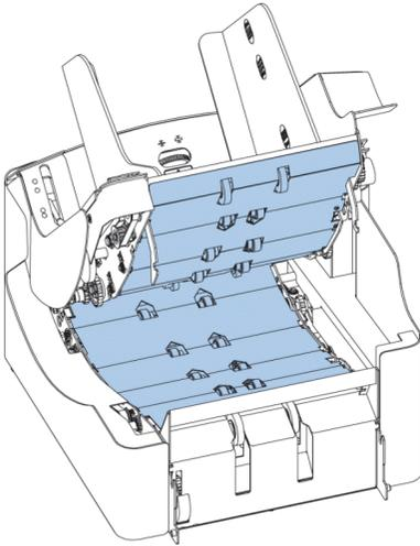
3. Die Dokumente aus dem Transportbereich und von der Rückseite der Separationsrollen entfernen.
