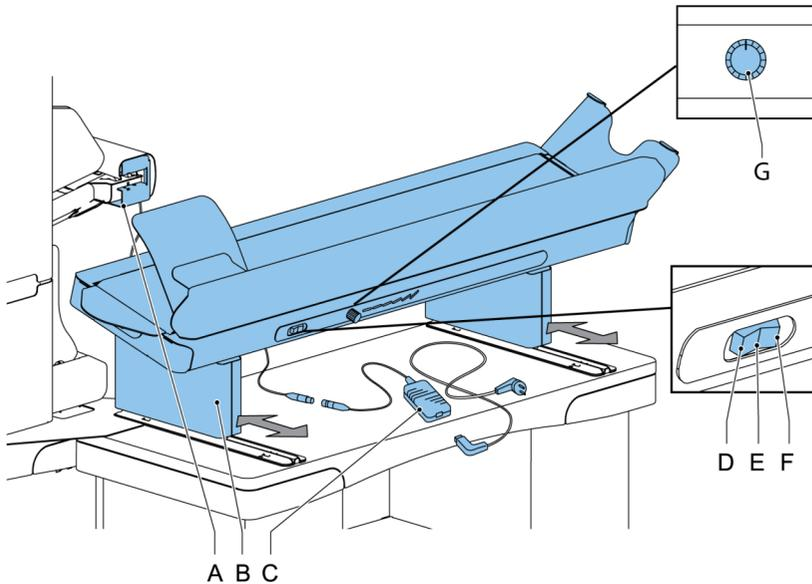
Mit dem Drehknopf (**G**) kann der Intervallabstand zwischen Kuverts auf dem Transportband eingestellt werden. Der Abstand ist abhängig von der Art des Jobs und von den Bedieneinstellungen.
