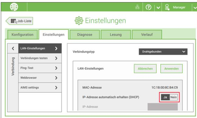
6. Legen Sie für **Automatically obtain IP address (DHCP)** entweder **Yes** oder **No** fest. Bei "Yes" wird das System automatisch mit dem LAN verbunden. Bei "No" muss die Verbindung manuell eingerichtet werden. Geben Sie die erforderlichen Details zur Einrichtung einer manuellen Verbindung ein.
