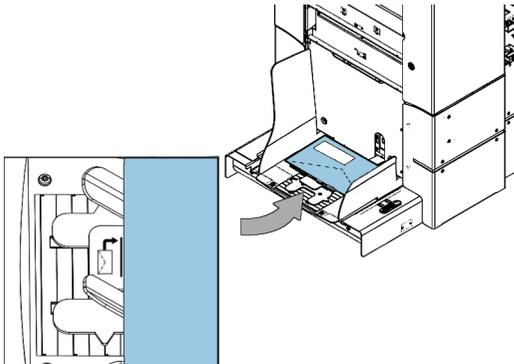
3. Kuvertstütze drehen, um das Gewicht der Kuverts auf beiden Seiten gleichmäßig zu verteilen.
