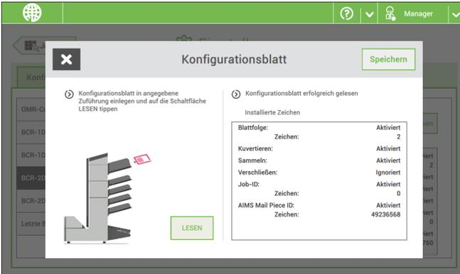
Mithilfe des BCR-2D-Konfigurationsblatts unter "Lesung" können Sie ein Konfigurationsblatt lesen. Das Ergebnis wird auf diesem Bildschirm sowie auf dem Bildschirm "BCR-2D-Codedefinition" dargestellt. Siehe [Lesen eines Konfigurationsblattes](#).
