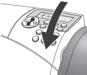
Das Bedienfeld in die Ausgangslage zurückklappen.
