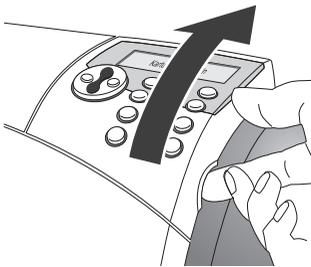
Das Bedienfeld bis zum Anschlag nach oben klappen. Es rastet in dieser Stellung ein. Die MyMail bringt die Tintenkartusche in die Wechselposition.
