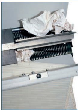
Schneidwellen aus speziell gehärtetem Stahl
