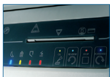
Bedienung über Touch-Board-Tastatur, LED-Leuchtanzeigen für alle Funktionen
